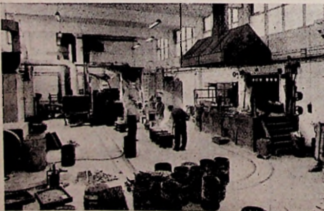
GEZICHT IN DE GIETERIJ, met rechts de hoogfrequent-smeltoven. De alliage voor de magneten wordt gesmolten bij 1800° C.
