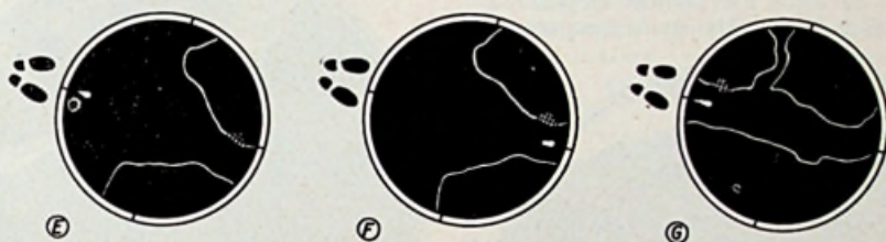
Zo ziet fig. B er uit, wanneer die schipper True motion zou hebben: E: het schip vaart in het radarbeeld; F: het nadert het einde van het scherm; G: en nu beginnen we snel een nieuw stukje Schelde.
